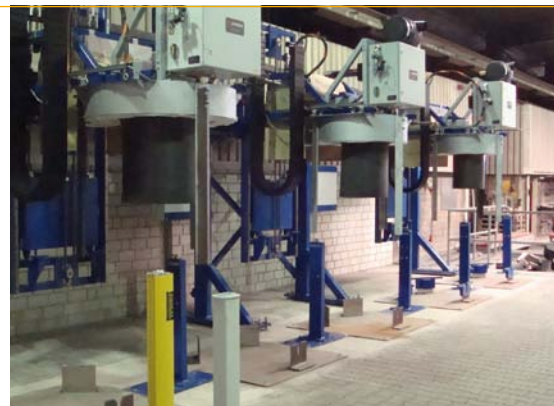
Die neue Pfannenaufheizstation arbeitet mit Infrarotstrahlung und Konvektion.
