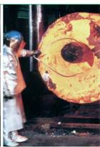
Formfehler). Speziell bei der Produktion von Ringen wird eine Gewichtsreduzierung von ca. 3 Prozent des Einsatzgewichts erzielt. Bei 32.000 t Ringen pro Jahr sind das 1.000 t/a, was rund 1 Mio. Euro entspricht. Insgesamt führen die umgesetzten Maßnahmen zu Einsparungen von mehr als 1 Mio. Euro pro Jahr. Die z.T. unvermeidlichen Materialverluste von rund 20.000 t hochwertigen Einsatzmaterials konnten spürbar verringert werden.
