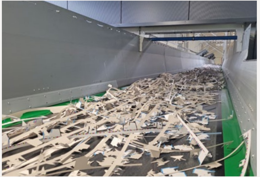
Bei der Firma WS Quack + Fischer werden heute Stanzabfälle flexibel über Flur abtransportiert – das spart Energie und senkt Lärmemissionen.
