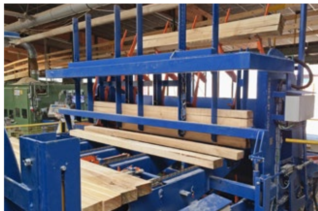
Neben der Kappanlage erneuerte der Holzpalettenproduzent auch die nachgelagerte Stapelmaschine.
